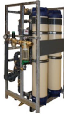
■ Anlage mit Doppelmodul Kontinuierlicher Wasserfluss Membranfläche: 2 x 60 m 2 = 120 m 2 Durchflussrate: ca. 6.000 l/h
